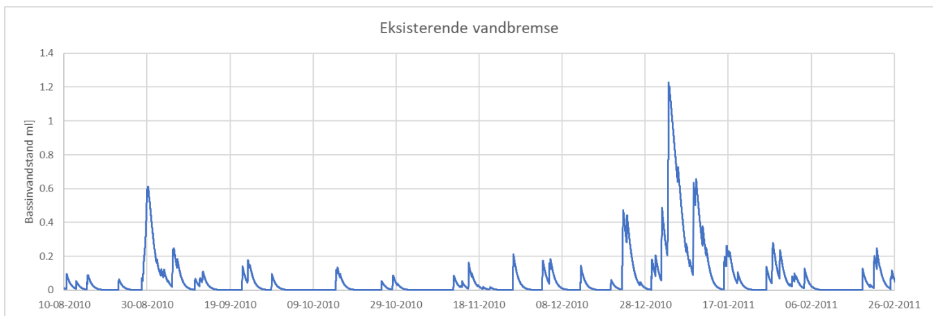
Figur 5-9 Zoom af Figur 5-8 - bassinvandsstanden med den eksisterende vandbremse. Fokus er på overløbet, som sker den 02/01-2011
