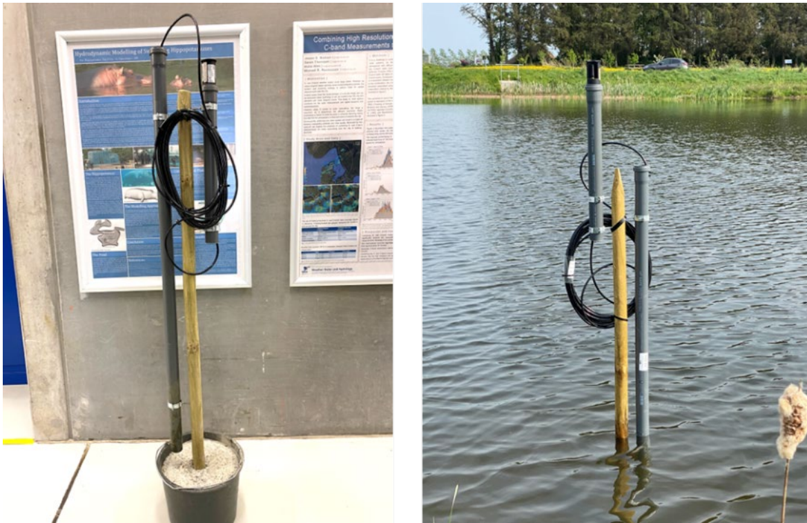
Figur B3.3: Opstilling til måling af vandstand i bassiner.
