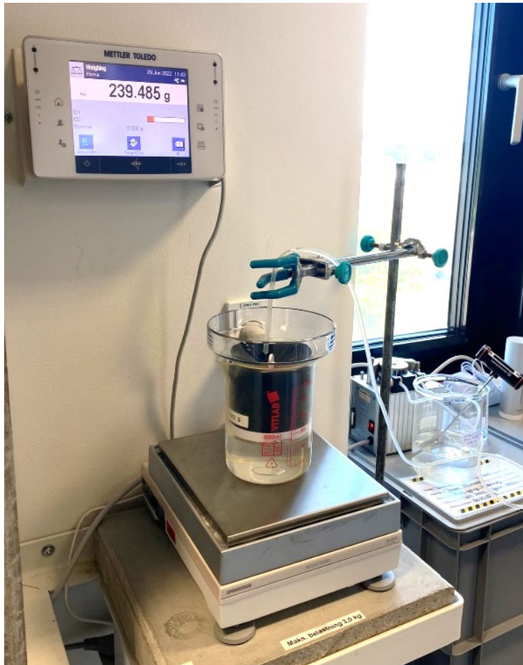
Figur B1.3: Forsøgsopstilling til test af Netatmo nøjagtighed i laboratorium med kendt regnintensitet.
