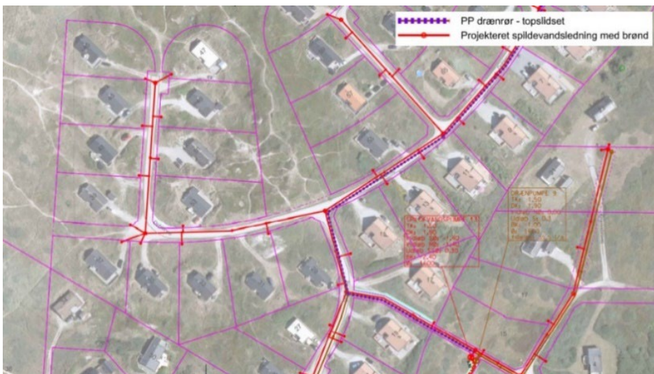
Dræn- og spildevandsledninger med hhv. lilla og rød farve
