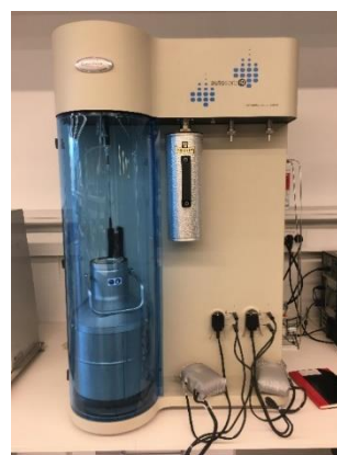
Figur 6: BET-analyse til at bestemme indre overfladeareal af de fraktionerede og det oprindelige størrelse aktivt kul.
