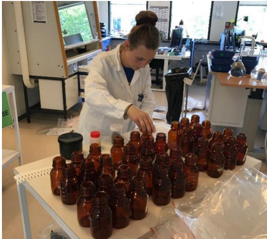
Figur 2. Sorptionsforsøg i HOFORs vandkvalitetslaboratorium. Til venstre: Opsætning af flasker med forskellige produkter; Til højre: Forsøgsopstilling med flasker på magnetomrører.
